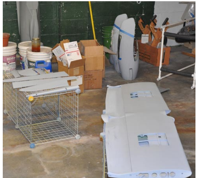
Primer håller på att torka på alla delar till Westland Whirlwinden som vi håller på att restaurera.
