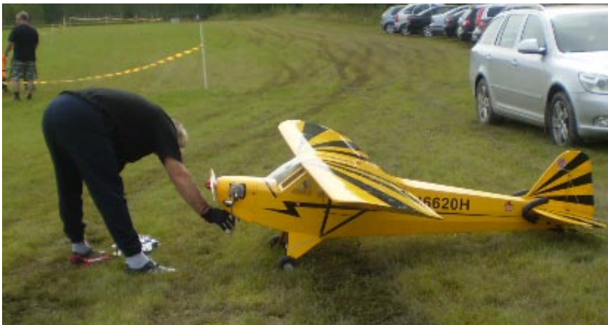
Kurt Nygren var en av de långväga gästerna. Han hade med sig en stor Piper Cub. I nosen sitter en OS Alpha 81 fyrtaktare. Till höger ses hans YAK.
