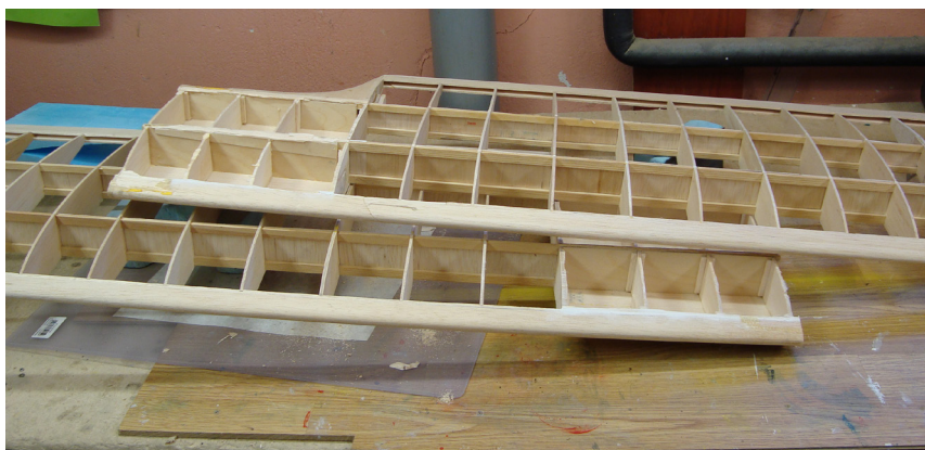
Här är mittsektionen avsågad och plankningen bortrensad.
