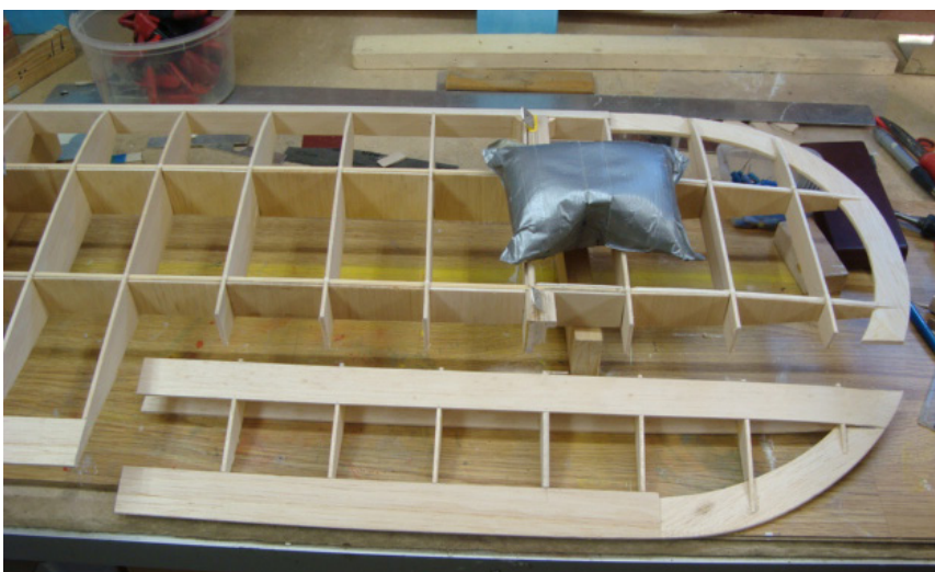
Skevrodret sågat. Blypåsen håller vingen pressad mot jiggen för att undvika skevheter.
