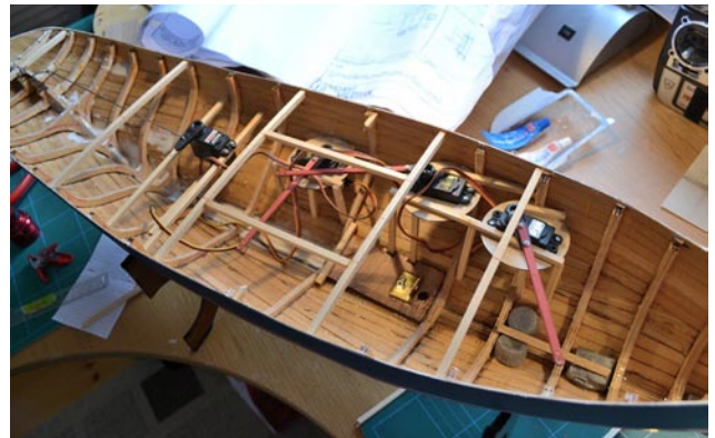
Elektroniken installerad. Servona har fått förlängda armar för att kunna dra in och släppa ut skoten tillräckligt.
