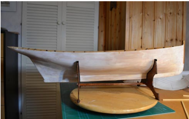
Skrovet slipat och klart för målning.
