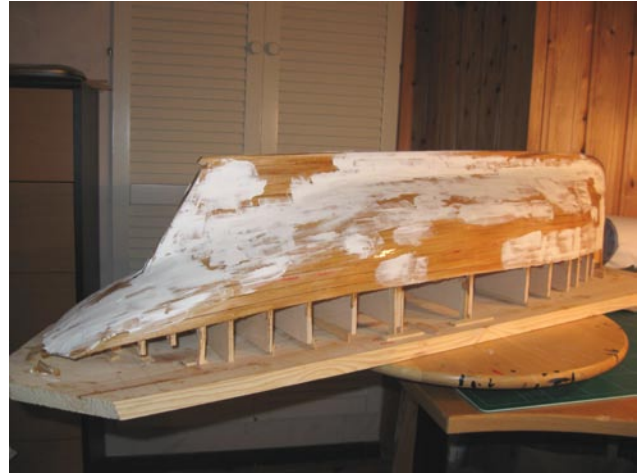
Spanten är bordlagda och spackling/slipning kan börja.
