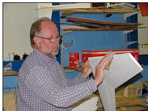
Elias Koinberg klär modellen med den färgade tejen som Per köpt från Danmark. Underst ligger glasfibrertejp som förstärkning.
