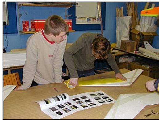
Elias Koinberg klär modellen med den färgade tejen som Per köpt från Danmark. Underst ligger glasfibrertejp som förstärkning.
