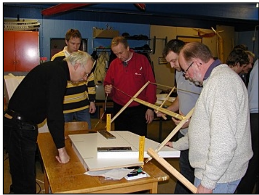
Station 1, att skära till vingämnena ur det stora cellplastblocket.
